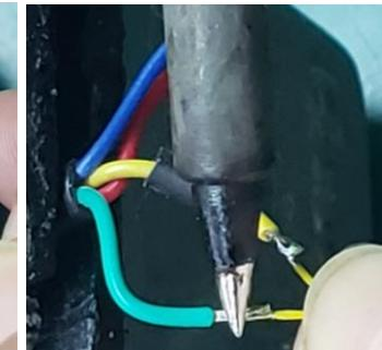
13° Aplicar calor al thermofit con pistola de calor..
